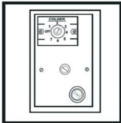
ⓘ Ne sélectionner pas le valeurs extrêmes . Si on sélectionne à l'extrême gauche l'appareil s'arrête. Autrement, à la droite, l'appareil va produire en excès. Il faut donc arrêter la machine. Vous pouvez faire fondre les glaçons plus vite si on verse de l'eau bouillante au-dessus.
